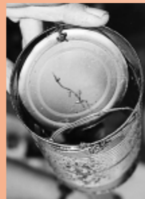
Charlie attache une vieille boîte à conserves à un bâton et l'utilise pour retirer, mélanger ou verser le purin. Pour réellement bien mélanger le purin dans le digesteur, il adapte cet outil et lui ajoute une simple valve. Il découpe le fond de la boîte et le fixe sur l'un des côtés grâce à un fil de fer, et utilise une boucle de fil de fer plus grosse pour bloquer l'autre côté. Ce qui lui permet de remonter le purin du fond du bidon et de bien le mélanger.
