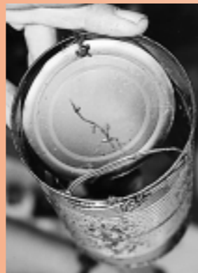
Charlie ata una lata usada a un palo y usa esto para quitar, mezclar y verter el fango. Para mezclar eficazmente el fango en el colector, él adapta esta herramienta y agrega una válvula simple. Quita la base de la lata y permite que pivotee hacia el lado mediante un alambre y usa un anillo de alambre más grande como soporte al otro lado. Esto le permite extraer fango de la base del tambor y mezclarlo bien.
