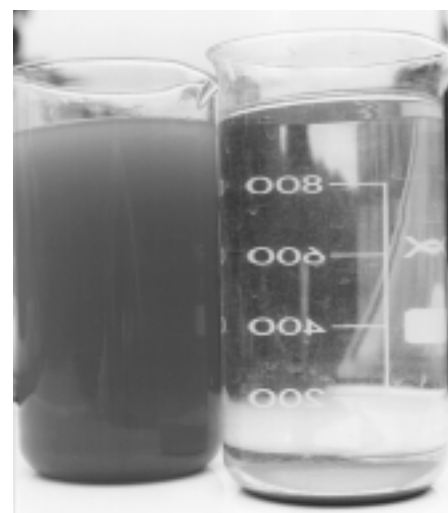
Água de rio sem tratamento (esquerda) depois de 2 horas de sedimentação. À direita está a água tratada com a solução da semente da moringa e deixada para sedimentar por 30 minutos.
